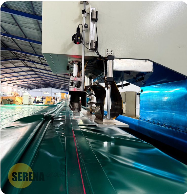
Hochfrequenz-Soundmaschine auf einem 30 Meter langen Tisch
