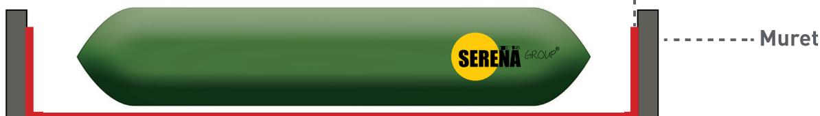
Les étapes suivantes à suivre pour la réalisation de la plateforme sont les mêmes qu'évoquée précédemment. Le tapis de sol devra être fixé sur le haut du muret grâce aux œillets dont il est muni.
